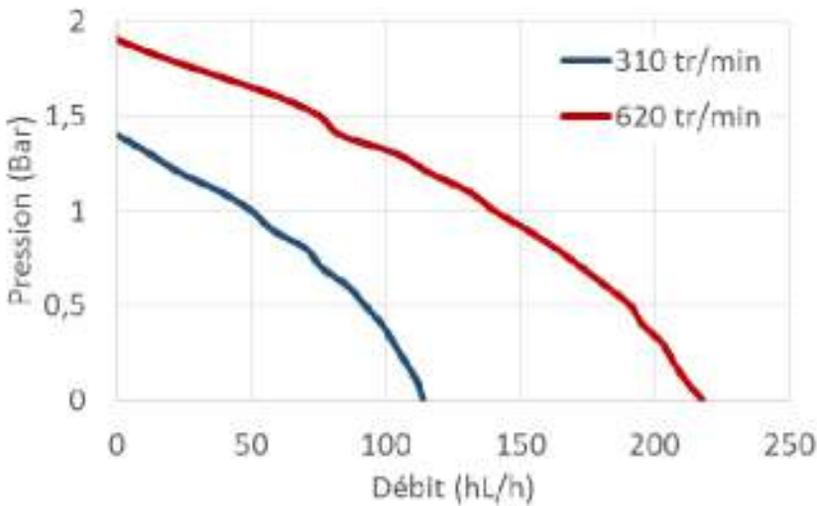
Essais effectués avec 3m de tuyau dans une eau à 10°C. Les pertes de charges peuvent être différentes selon la tuyauterie utilisée, la nature du produit véhiculé et l'impulseur.
