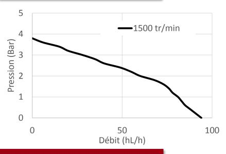
Essais effectués avec 5m de tuyau dans une eau à 15°C. Les pertes de charges peuvent être différentes selon la tuyauterie utilisée, la nature du produit véhiculé et l'impulseur.
