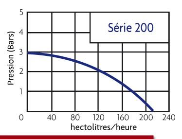
Essais effectués avec 10m de tuyau dans une eau à 10°C. Les pertes de charges peuvent être différentes selon la tuyauterie utilisée, la nature du produit véhiculé et l'impulseur.
