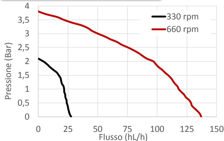
Queste prove sono state effettuate con 3 metri di tubo in aspirazione e in scarico con acqua a 15°C. Le perdite di carico dipendono dalla lunghezza dei tubi utilizzati, dalla natura del prodotto trasportato e dal girante.
